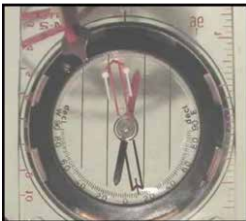
Figure 18-1-6 Vis de déclinaison
